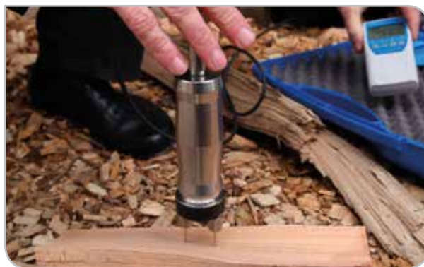
De vochtigheidsgraad van het hout wordt gemeten. In de open lucht kan men drogen tot 20-30% vochtgehalte.
